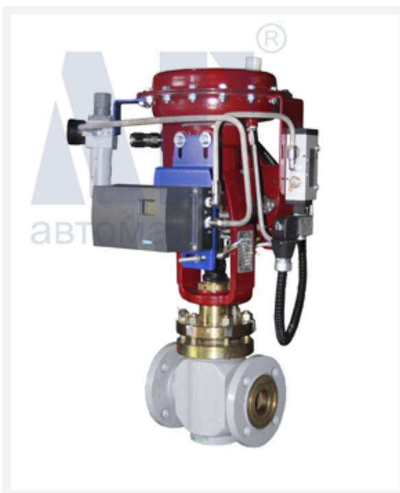
Регулирующе-отсечные (запорно-регулирующие) клапаны КМРО могут не только регулировать, но и быстро открывать и закрывать трубопровод с герметичностью. Для управления клапаном КМРО обычно используется схема управления, включающая позиционер и электромагнитный клапан.
